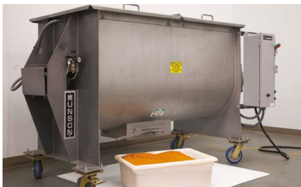
Le mélangeur de Munson, série HD, assure des mélanges homogènes sans apparition de grumeaux.
